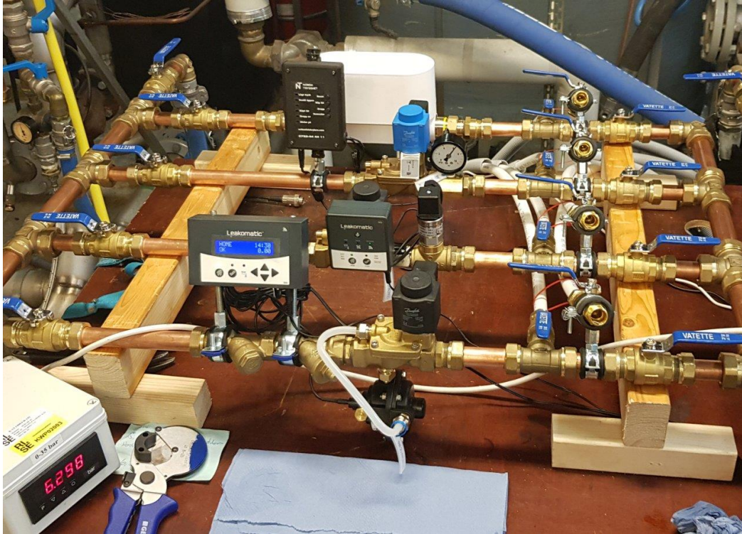
Figur 1, inkopplade vattenfelsbrytare. Från topp nr.1 Grohe Sense Guard, nr.2 Nordia NT-100, nr.3 Leakomatic M3i, nr.4 Leakomatic M4i
