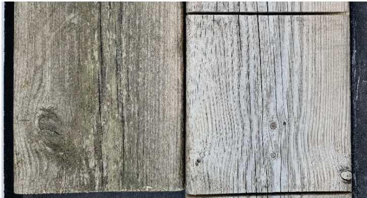
Figur 3 Obehandlad referensyta till vänster, skurad yta till höger. Altanbrädor.
