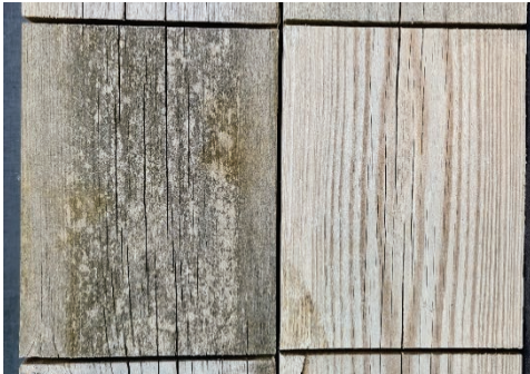
Figur 10 Produkt 26. Obehandlad referensyta till vänster, skurad yta till höger. Staketbrädor.
