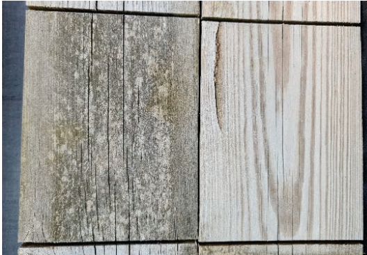
Figur 4 Produkt 2. Obehandlad referensyta till vänster, skurad yta till höger. Staketbrädor.
