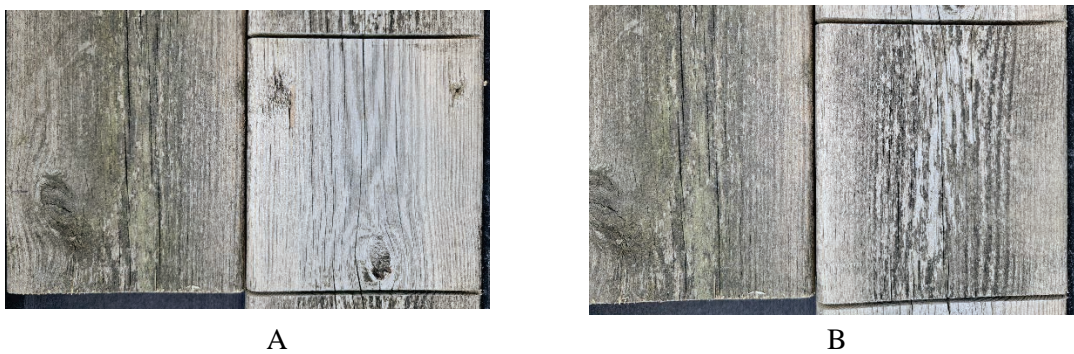
Figur 7 Produkt 11, altanbrädor. (A) Obehandlad referensyta till vänster, skurad yta till höger. (B) obehandlad yta till vänster, yta med påfört medel utan skurning till höger.
