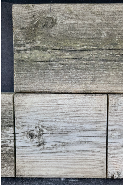
Figur 18 Produkt 40. Obehandlad referensyta överst, skurad yta nederst. Altanbrädor.
