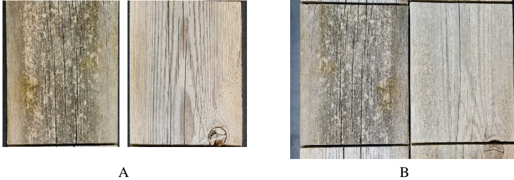
Figur 6 Produkt 11, staketbrädor. (A) Obehandlad referensyta till vänster, skurad yta till höger. (B) obehandlad yta till vänster, yta med påfört medel utan skurning till höger.
