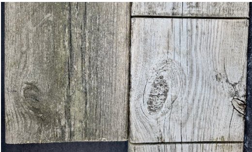
Figur 11 Produkt 26. Obehandlad referensyta till vänster, skurad yta till höger. Altanbrädor.
