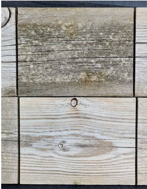
Figur 12 Produkt 32, staketbrädor. (A) Obehandlad referensyta till överst, skurad yta underst. (B) obehandlad yta överst, yta med påfört medel utan skurning underst.
