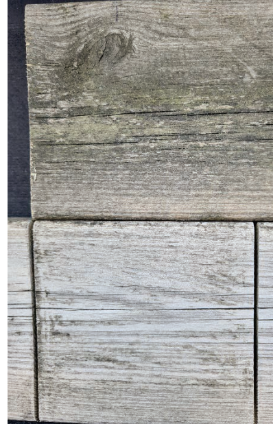
Figur 12 Produkt 32, staketbrädor. (A) Obehandlad referensyta till överst, skurad yta underst. (B) obehandlad yta överst, yta med påfört medel utan skurning underst.
