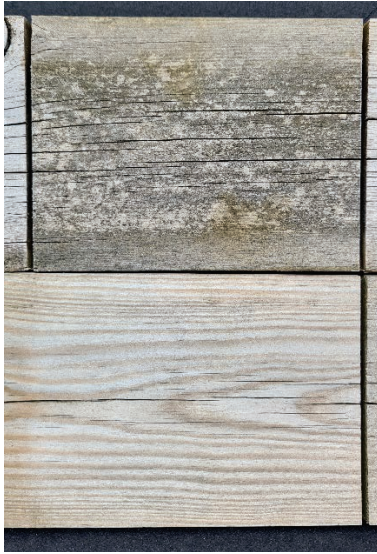
Figur 16 Produkt 39, staketbrädor. (A) Obehandlad referensyta överst, skurad yta underst. (B) obehandlad yta överst, yta med påfört medel utan skurning underst.
