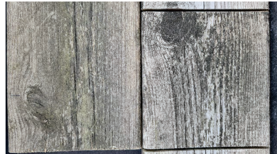
Figur 8 Produkt 17, staketbrädor. (A) Obehandlad referensyta till vänster, skurad yta till höger. (B) obehandlad yta till vänster, yta med påfört medel utan skurning till höger.
