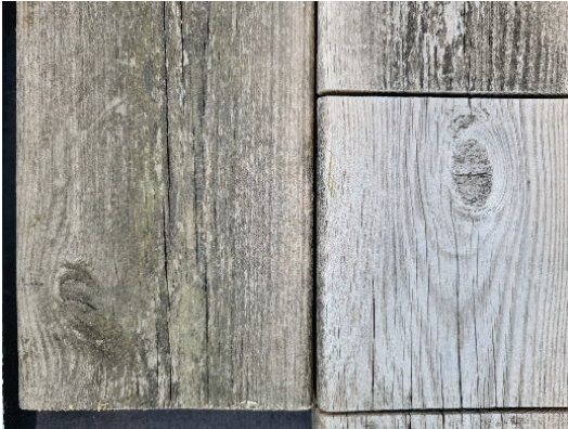
Figur 5 Produkt 2. Obehandlad referensyta till vänster, skurad yta till höger. Altanbrädor.
