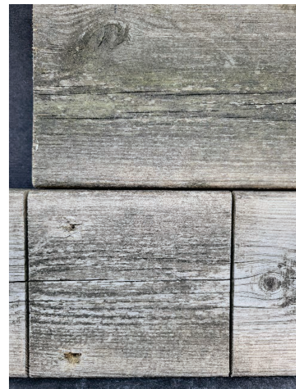
Figur 16 Produkt 39, staketbrädor. (A) Obehandlad referensyta överst, skurad yta underst. (B) obehandlad yta överst, yta med påfört medel utan skurning underst.
