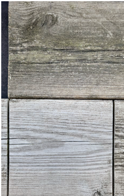
Figur 12 Produkt 32, staketbrädor. (A) Obehandlad referensyta till överst, skurad yta underst. (B) obehandlad yta överst, yta med påfört medel utan skurning underst.
