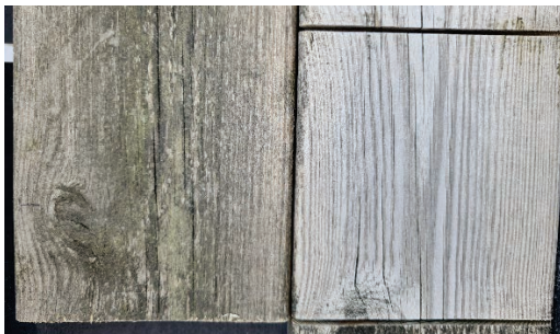
Figur 8 Produkt 17, staketbrädor. (A) Obehandlad referensyta till vänster, skurad yta till höger. (B) obehandlad yta till vänster, yta med påfört medel utan skurning till höger.
