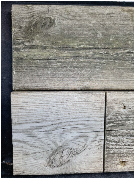
Figur 17 Produkt 39, altanbrädor. (A) Obehandlad referensyta överst, skurad yta underst. (B) obehandlad yta överst, yta med påfört medel utan skurning underst.
