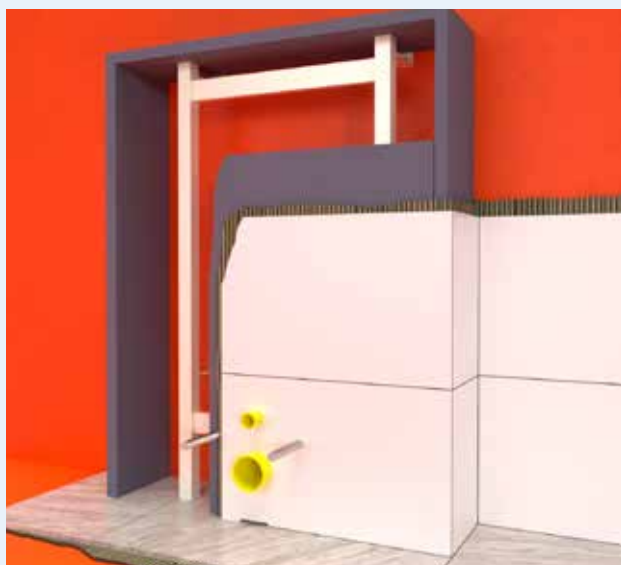
Tätskikt bakom inbyggd wc-stol med inbyggd vattenbehållare.
