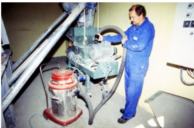
I foderberedningsanläggningar, spannmålslager och liknande utrymmen samlas stora mängder damm och boss. Rengör dessa utrymmen regelbundet. Tjocka lager av damm på arbetande motorer kan orsaka varmgång och antändning.
