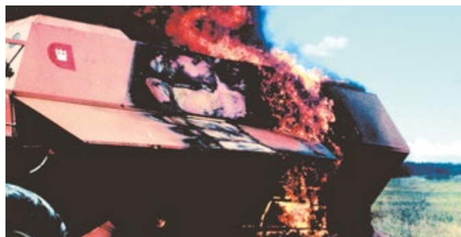
Undvik brand i din tröska. Blås ren tröskan med tryckluft efter varje tröskningsdag.
