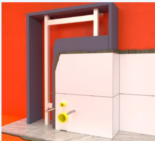
Tätskikt bakom inbyggd wc-stol med inbyggd vattenbehållare.
